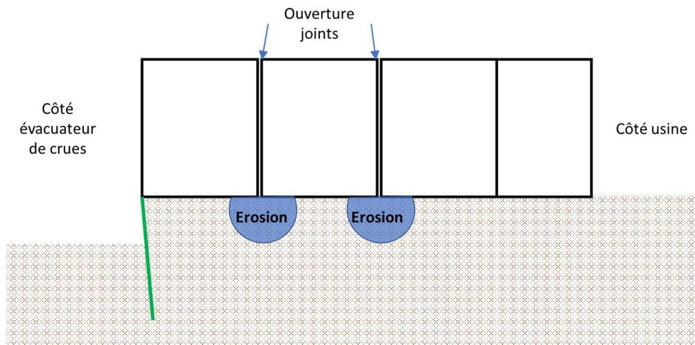
L'agrandissement de la zone d'érosion entraîne un tassement du bloc central, et un basculement des deux blocs adjacents.
