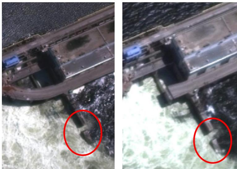
Pour qu'un tel bloc massif de béton se déplace, cela suppose à priori que la fondation s'est elle aussi déplacée.
